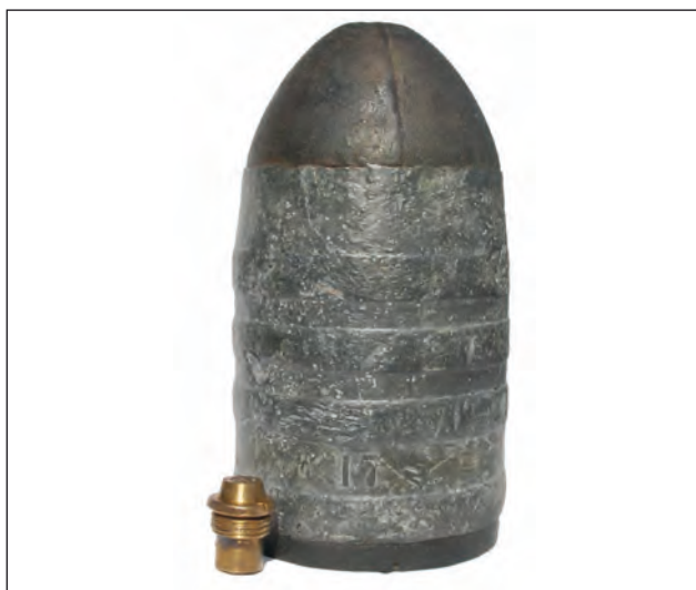
8. ábra. A 15 cm-es 1861/1M gránát és gyújtószerkezete
