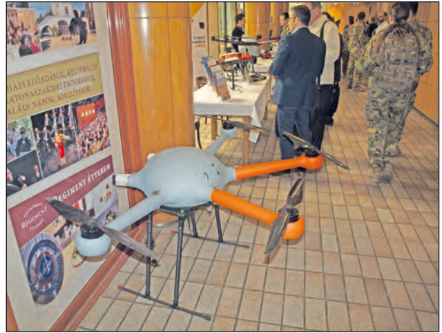
7. ábra. Hazai fejlesztésű, Gigarotor-6 típusjelzésű villamos hajtású helikopter-UAV (a két hátsó rotortartó konzol leszerelt állapotban van) (Fotó: Sz. A.)
