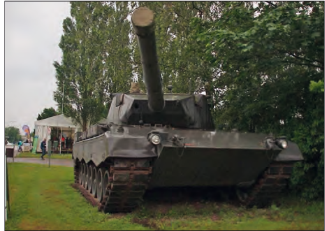
4. ábra. A Leopard 2 PT15 T02-es prototípusa 105 mm-es löveggel felszerelve, a németországi Trierben
