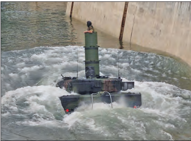
8. ábra. Egy Leopard 2-es harckocsi a mélyvízi átkelést demonstrálja. A torony búvónyílására szerelt „légzőcsővön” keresztül jut levegőhöz a legénység és a motor a víz alatti haladás során
