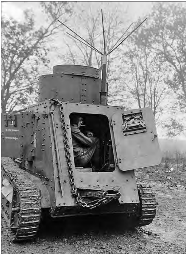
18. ábra. A rádióval is felszerelt parancsnoki Strv m/21-es, nyitott búvónyílással
