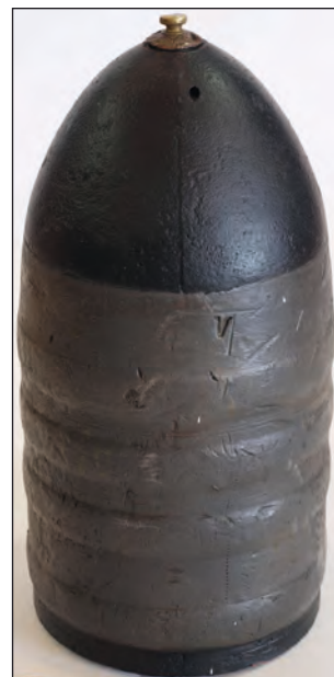
2. ábra. 15 cm-es 1861M gránát a gyújtószerkezetével
