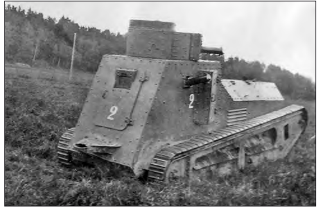
19. ábra. Az LK II / Strv m/21 két oldalán, valamint elől a vezető mellett és hátul a búvónyíláson/ajtón kialakított, páncélzattal lezárható nyílásokba összesen akár 4 darab további géppuskát is el lehetett helyezni gyalogság elleni másodlagos fegyverzetként. A gyakorlatban általában 1, maximum 2 darabnál többet nem szereltek be, s gyakran teljesen mellőzték is ezeket a további géppuskákat. A képen a 2-es számú Strv m/21-es látható, oldalsó kiegészítő géppuskával is ellátva
