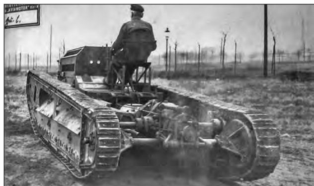
12. ábra. A Steffen & Heymann által felajánlott „lánctalpas nehéz vontató” fényképe, amelyet az 1921. márciusi ajánlattételükhöz is csatoltak. A képen könnyen felismerhető a páncélborítás és felépítmény nélküli LK II alváza
