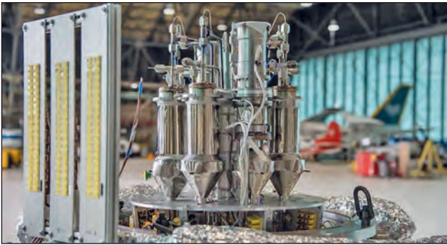
8. ábra. A Stirling-motoros energia-átalakító egység szerelés közben (Forrás: NNSA)
