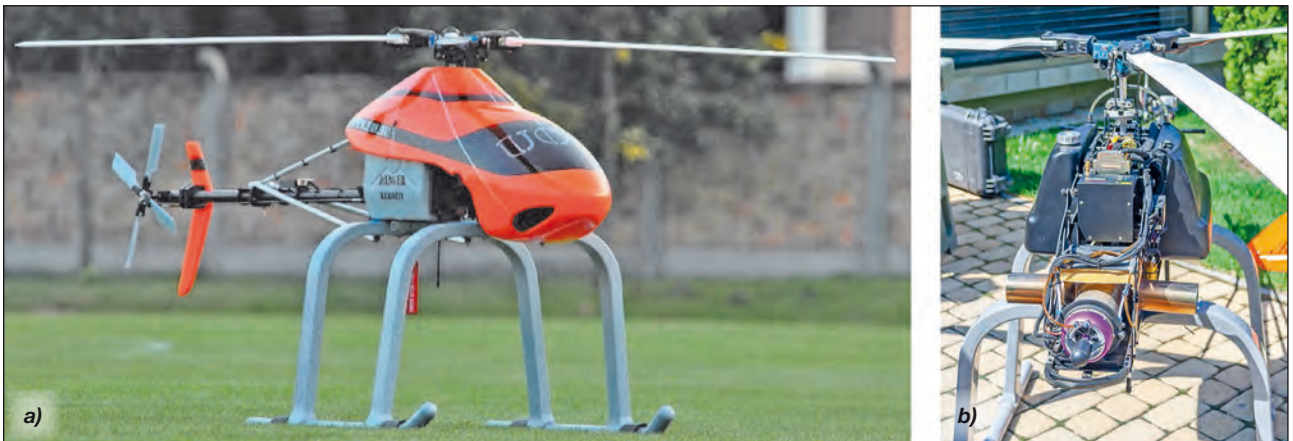
6. ábra. A hazai fejlesztésű, UC-2 típusjelzésű gázturbinás helikopter-UAV (b jelű fotó: M. B.)
